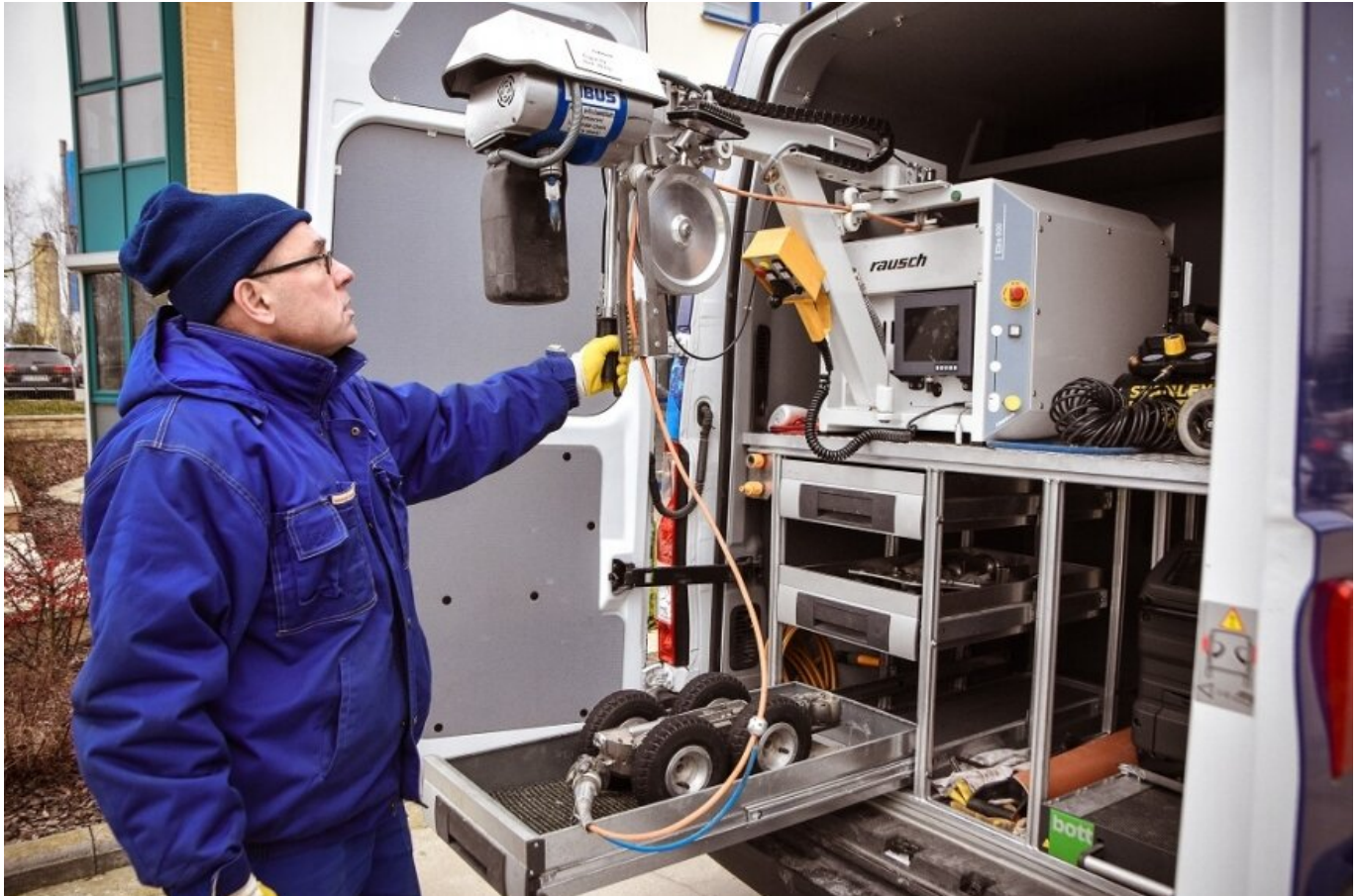
Samochód Wod-Kan służący do monitorowania wnętrza rur kanalizacyjnych za pomocą samojezdnej kamery. (Fot. Sławomir Burzyński)
